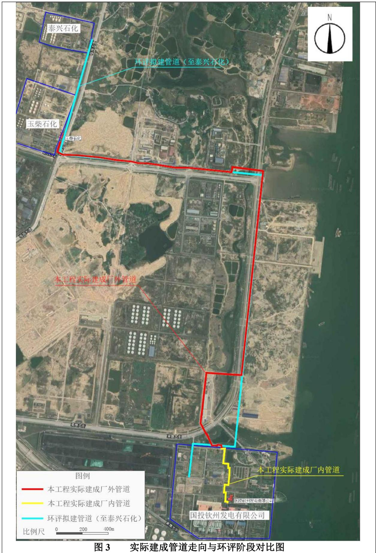
图3 实际建成管道走向与环评阶段对比图
